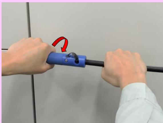
① 工具をケーブルへ挿して回す。
