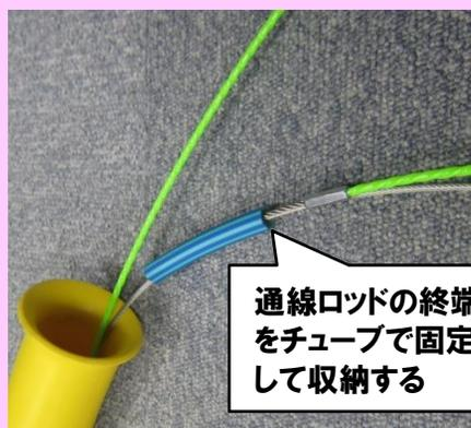
通線ロッドの終端をチューブで固定して収納する
