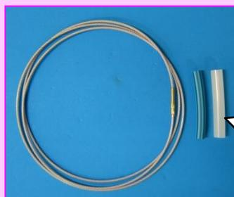
ロッドの先端の外径に合ったチューブを使用
