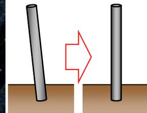
③水平器の気泡を確認し、電柱の傾斜を直す
