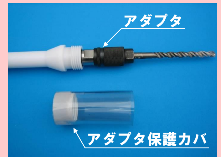
ドリル刃交換時はアダプタ保護カバを取り外します
