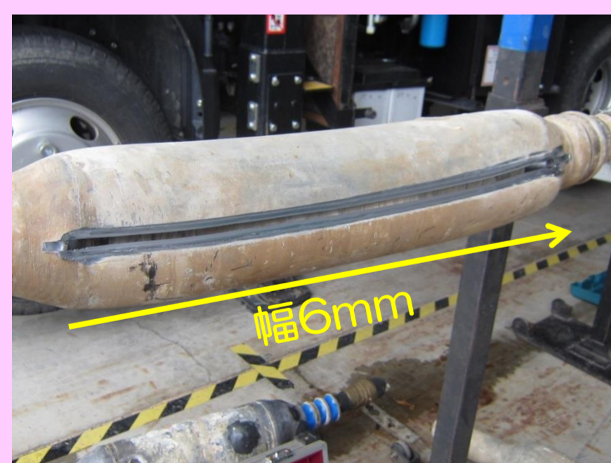
①主鉛管を縦割り
