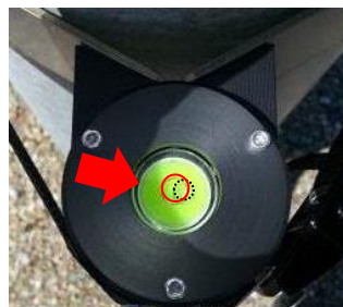
③水平器の気泡を確認し、電柱の傾斜を直す ※気泡の方向に電柱を傾ける(写真の矢印方向)
